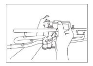
C. Stecken Sie das Ventil zurück in das Ventilgehäuse und stellen Sie die richtige Positionierung der Ventilführung in der Führungsnut sicher. Drücken Sie das Ventil einige Male um das Öl zu verteilen.
